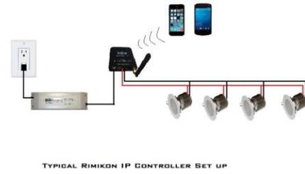
3) TYPICAL RIMIKON IP CONTROLLER SET UP
